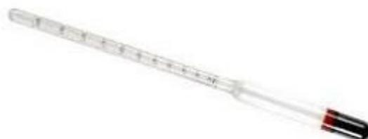
*Figura 1. Aerómetro utilizado en el laboratorio.*
