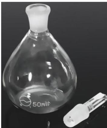
*Figura 2. Picnómetro utilizado en el laboratorio*
